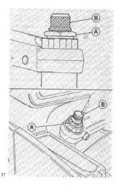
Nel tempo a seguito di notevoli percorrenze, per compensare la naturale usura degli ammortizzatori può essere necessario utilizzare una regolazione superiore a quella sopra indicata.
